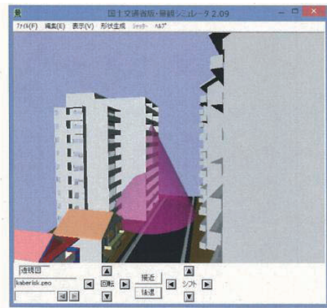
図 外壁はく落危険性を可視化したビューワーの例
