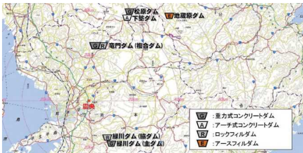
図-1 地震後の臨時点検で変状が報告されたダム
