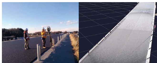
図 レーザー scanner による出来形計測 (左) と取得点群データ (右)
