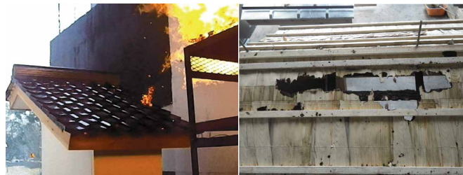
写真1 火の粉による出火実験 写真2 屋根下地の燃え抜け例
