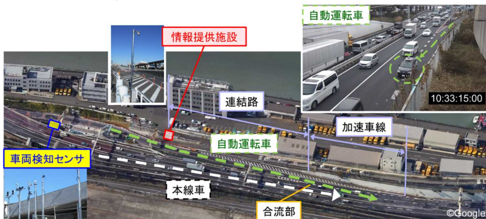
図 1 実道での合流支援情報提供システムの効果検証実験（東京臨海部実証実験） 出典：Google map をもとに作成
