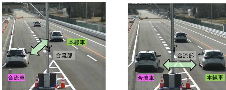
図 2 合流部付近での合流車と本線車の位置関係 （左：情報提供がある場合、右：情報提供がない場合）
