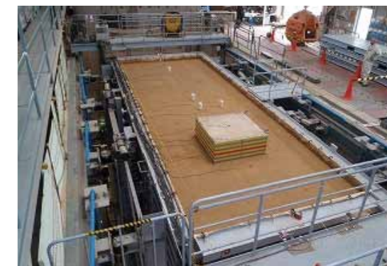
実験に用いた大型せん断土槽による試験体地盤
