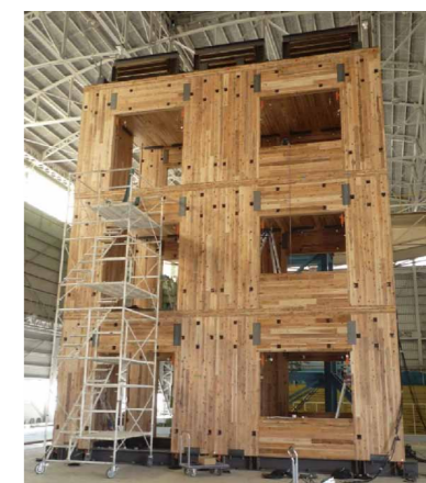
CLTパネル構造試験体
