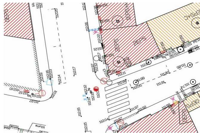
埋設物件の位置を記録したDB図面の例 (仏国の例)
